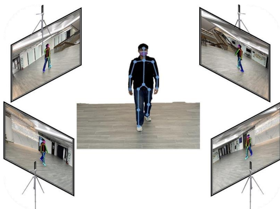
圖3：無標記式三維動作捕捉系統架構與處理流程示意圖。 本系統透過多台攝影機同時從不同角度擷取人體動作影像，並利用電腦視覺演算法自動辨識人體二維關鍵點。接著，運用幾何三角重建與濾波技術，將來自不同視角的二維關節位置融合為對應的三維空間座
